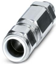
Kabelverschraubung, Material Verschraubung: Edelstahl 316L, Anwendung: Ex, Kabelaußendurchmesser 40,4 mm ... 53,1 mm, Schirmung: ja, Anschlussgewinde: M50 x 1,5, Farbe: silberfarben
