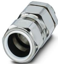
Kabelverschraubung, Material Verschraubung: Messing, vernickelt, Anwendung: Ex, Kabelaußendurchmesser 18,2 mm ... 26,2 mm, Schirmung: ja, Anschlussgewinde: M25 x 1,5, Farbe: silberfarben
