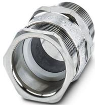
Kabelverschraubung, Material Verschraubung: Edelstahl 316L, Anwendung: Ex, Kabelaußendurchmesser 23,5 mm ... 32,2 mm, Schirmung: nein, Anschlussgewinde: M40 x 1,5, Farbe: silberfarben
