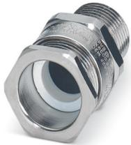
Kabelverschraubung, Material Verschraubung: Edelstahl 316L, Anwendung: Ex, Kabelaußendurchmesser 11,1 mm ... 20 mm, Schirmung: nein, Anschlussgewinde: M25 x 1,5, Farbe: silberfarben
