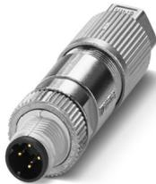
Datensteckverbinder, PROFINET CAT5 (100 MBit/s), 4-polig, halogenfrei, geschirmt, Stecker gerade M12, Kodierung: D, Schneidklemmanschluss, Rändelmaterial: Zinkdruckguss, vernickelt, Leitungsaußendurchmesser 5 mm ... 9,7 mm
