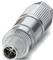
Datensteckverbinder, PROFINET CAT6<sub>A</sub> (10 GBit/s), 8-polig, halogenfrei, geschirmt, Stecker gerade M12, Kodierung: X, Schneidklemmanschluss, Rändelmaterial: Zinkdruckguss, vernickelt, Leitungsaußendurchmesser 5 mm ... 9,7 mm
