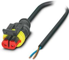
Sensor-/Aktor-Kabel, 2-polig, PUR halogenfrei, schwarzgrau RAL 7021, freies Leitungsende, auf Buchse gerade Superseal Clipverriegelung, Kodierung: A, Kabellänge: 5 m
