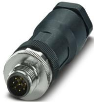
Steckverbinder, Universal, 8-polig, Stecker gerade M12, Kodierung: A, Schraubanschluss, Rändelmaterial: Messing, vernickelt, Kabelverschraubung Pg11, Leitungsaußendurchmesser 8 mm ... 10 mm
