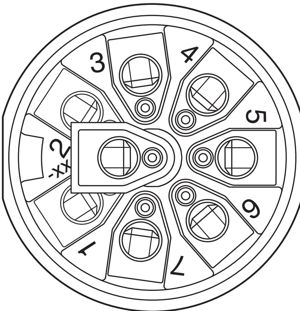
Kabelanschlusseite M12 (Schraubanschluss)
