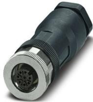
Steckverbinder, Universal, 8-polig, Buchse gerade M12, Kodierung: A, Schraubanschluss, Rändelmaterial: Messing, vernickelt, Kabelverschraubung Pg11, Leitungsaußendurchmesser 8 mm ... 10 mm
