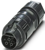
Kupplungssteckverbinder, Artikelfamilie: PRC 35, Bauform: Entriegelung nur mit Werkzeug, Farbe: schwarz, Polzahl: 3, Aderquerschnitt min.: 1,5 mm<sup>2</sup>, Aderquerschnitt max.: 6 mm<sup>2</sup>, Bemessungsspannung: 690 V AC, Bemessungsstrom: 35 A, Anschlussart: Schraubanschluss, Kabeldurchmesser min.: 8 mm, Kabeldurchmesser max.: 21 mm, Variante zur Entriegelung mit einem Werkzeug
