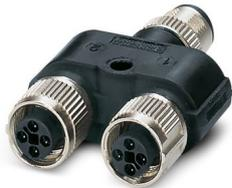
Y-Verteiler, 4-polig, Stecker gerade M12, Kodierung: T, auf Buchse gerade M12, Kodierung: T und Buchse gerade M12, Kodierung: T, für Gleichstrom bis 12 A / 63 V
