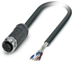
Bussystem-Kabel, CANopen®, DeviceNet™, 5-polig, FRNC halogenfrei, schwarz, geschirmt, freies Leitungsende, auf Buchse gerade M12, Kodierung: A, Kabellänge: 2 m, für Außenanwendungen, mit Edelstahlrändel
