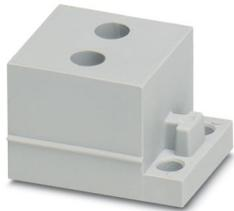
Kabeltülle, klein, Anzahl der Leitungen: 2, Ausführung: Rundkabel, geschlitzt, Leitungsaußendurchmesser: 2x 2,4 mm ... 2,7 mm, Material: SEBS (halogenfrei), Farbe: grau, Länge: 29,5 mm, Breite: 19,5 mm, Höhe: 17 mm
