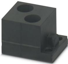
Kabeltülle, klein, Anzahl der Leitungen: 2, Ausführung: Rundkabel, geschlitzt, Leitungsaußendurchmesser: 2x 8 mm ... 9 mm, Material: NBR, Farbe: schwarz, Länge: 29,5 mm, Breite: 19,5 mm, Höhe: 17 mm
