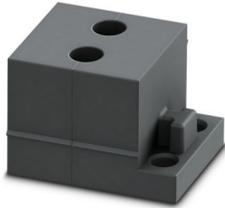
Kabeltülle, klein, Anzahl der Leitungen: 2, Ausführung: Rundkabel, geschlitzt, Leitungsaußendurchmesser: 2x 2 mm ... 3 mm, Material: NBR, Farbe: schwarz, Länge: 29,5 mm, Breite: 19,5 mm, Höhe: 17 mm
