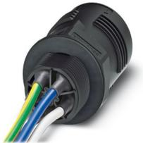
QUICKON-Wanddurchführung, 4+PE-polig, 2,5 mm<sup>2</sup>... 6,0 mm<sup>2</sup> / 690 V / 40 A, ohne QUICKON-Mutter, schwarz, M25-Anschlussgewinde mit 5 angeschweißten 6,0 mm<sup>2</sup> Leitungsadern, 1,0 m lang, am Ende glatt abgeschnitten.
