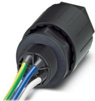
QUICKON-Wanddurchführung, 4+PE-polig, 2,5 mm<sup>2</sup>... 6,0 mm<sup>2</sup> / 690 V / 40 A, mit QUICKON-Mutter, schwarz, für Kabeldurchmesser 9 mm ... 14 mm, M25-Anschlussgewinde mit 5 angeschweißten 6,0 mm<sup>2</sup> Leitungsadern, 0,5 m lang, am Ende glatt abgeschnitten.
