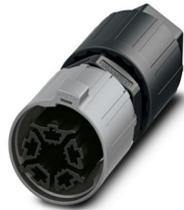
Steckverbinder, Anschlussart: IDC-Anschluss, Polzahl: 4+PE, 2,5 mm<sup>2</sup> ... 6 mm<sup>2</sup>, 690 V, 40 A, PA, schwarz, mit QUICKON-Mutter, Leitungsaußendurchmesser: 12 mm ... 20 mm
