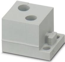
Kabeltülle, klein, Anzahl der Leitungen: 2, Ausführung: Rundkabel, geschlitzt, Leitungsaußendurchmesser: 2x 7,4 mm ... 7,7 mm, Material: SEBS (halogenfrei), Farbe: grau, Länge: 29,5 mm, Breite: 19,5 mm, Höhe: 17 mm
