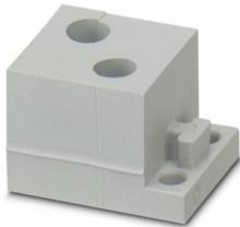
Kabeltülle, klein, Anzahl der Leitungen: 2, Ausführung: Rundkabel, geschlitzt, Leitungsaußendurchmesser: 2x 6,4 mm ... 6,7 mm, Material: SEBS (halogenfrei), Farbe: grau, Länge: 29,5 mm, Breite: 19,5 mm, Höhe: 17 mm
