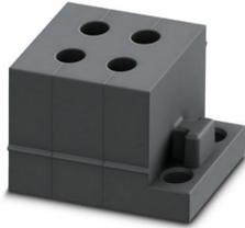
Kabeltülle, klein, Anzahl der Leitungen: 4, Ausführung: Rundkabel, geschlitzt, Leitungsaußendurchmesser: 4x 4 mm ... 5 mm, Material: NBR, Farbe: schwarz, Länge: 29,5 mm, Breite: 19,5 mm, Höhe: 17 mm
