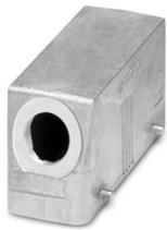
Tüllengehäuse B24, für Querbügel, Material: Aluminiumdruckguss, seewasserbeständig, Kabelabgänge: 1, seitlich, 1x M32, Höhe: 60 mm, Kabelverschraubung: ohne, Standard
