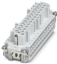
Kontakteinsatz, Polzahl: 24+PE, Baugröße: B24, Anzahl der Anschlüsse je Pol: 1, Buchse, Schraubanschluss, 500 V, 16 A, 0,5 mm<sup>2</sup> ... 2,5 mm<sup>2</sup>, Anwendung: Leistung
