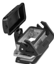
Anbaugehäuse B16, mit Längsbügel, Material: Aluminiumdruckguss, seewasserbeständig, Material Schutzdeckel: PC, Höhe: 30,5 mm, Kabelverschraubung: ohne, Schutzdeckel: ja, Standard, mit Flachdichtung
