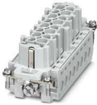
Kontakteinsatz, Polzahl: 16+PE, Baugröße: B16, Anzahl der Anschlüsse je Pol: 1, Buchse, Schraubanschluss, 500 V, 16 A, 0,5 mm<sup>2</sup> ... 2,5 mm<sup>2</sup>, Anwendung: Leistung
