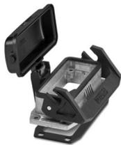
Anbaugehäuse B16, mit Längsbügel, Material: Aluminiumdruckguss, seewasserbeständig, Material Schutzdeckel: PC, Höhe: 30,5 mm, Kabelverschraubung: ohne, Schutzdeckel: ja, Standard, mit Flachdichtung
