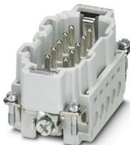
Kontakteinsatz, Polzahl: 10+PE, Baugröße: B10, Anzahl der Anschlüsse je Pol: 1, Stift, Schraubanschluss, 500 V, 16 A, 0,5 mm<sup>2</sup> ... 2,5 mm<sup>2</sup>, Anwendung: Leistung
