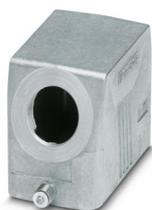
Tüllengehäuse B10, für Längsbügel, Material: Aluminiumdruckguss, seewasserbeständig, Kabelabgänge: 1, seitlich, 1x M25, Höhe: 57 mm, Kabelverschraubung: ohne, Standard
