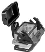
Anbaugehäuse B10, mit Längsbügel, Material: Aluminiumdruckguss, seewasserbeständig, Material Schutzdeckel: PC, Höhe: 30,5 mm, Kabelverschraubung: ohne, Schutzdeckel: ja, Standard, mit Flachdichtung
