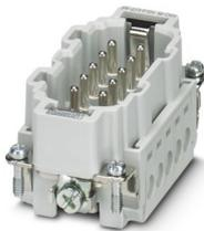
Kontakteinsatz, Polzahl: 10+PE, Baugröße: B10, Anzahl der Anschlüsse je Pol: 1, Stift, Schraubanschluss, 500 V, 16 A, 0,5 mm<sup>2</sup> ... 2,5 mm<sup>2</sup>, Anwendung: Leistung
