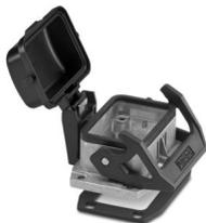
Anbaugehäuse B6, mit Längsbügel, Material: Aluminiumdruckguss, seewasserbeständig, Material Schutzdeckel: PC, Höhe: 30,5 mm, Kabelverschraubung: ohne, Schutzdeckel: ja, Standard, mit Flachdichtung
