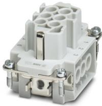
Kontakteinsatz, Polzahl: 6+PE, Baugröße: B6, Anzahl der Anschlüsse je Pol: 1, Buchse, Schraubanschluss, 500 V, 16 A, 0,5 mm<sup>2</sup> ... 2,5 mm<sup>2</sup>, Anwendung: Leistung
