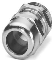
Kabelverschraubung, Material Verschraubung: Messing, vernickelt, Anwendung: Standard, Kabelaußendurchmesser 6 mm ... 12 mm, Schirmung: nein, Anschlussgewinde: M20 x 1,5, Farbe: silberfarben, mit O-Ring
