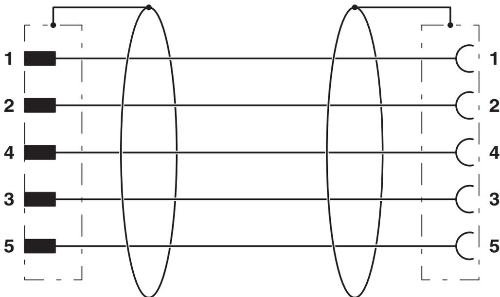
Kontaktbelegung des M12-Stecker und der M12-Buchse
