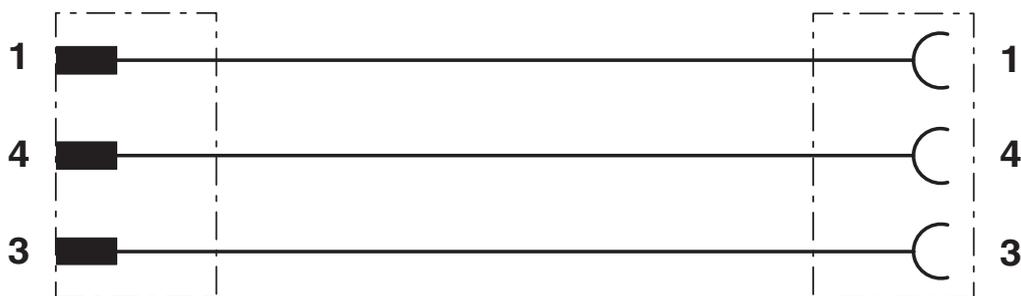
Kontaktbelegung des M12-Stecker und der M12-Buchse
