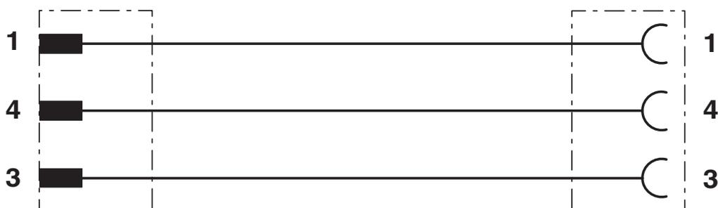
Kontaktbelegung des M12-Stecker und der M12-Buchse
