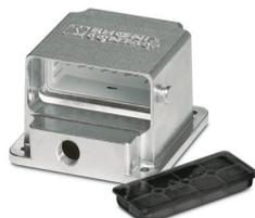
Motorseitiger Steckverbinder, Anbau-EMV-Metallgehäuse inkl. Crimp-Kontakteinsatz, mit Flachdichtung und Lackierschutzdeckel, ohne Crimpkontakte, Gehäuse mit lackierfähiger Dickschichtpassivierung
