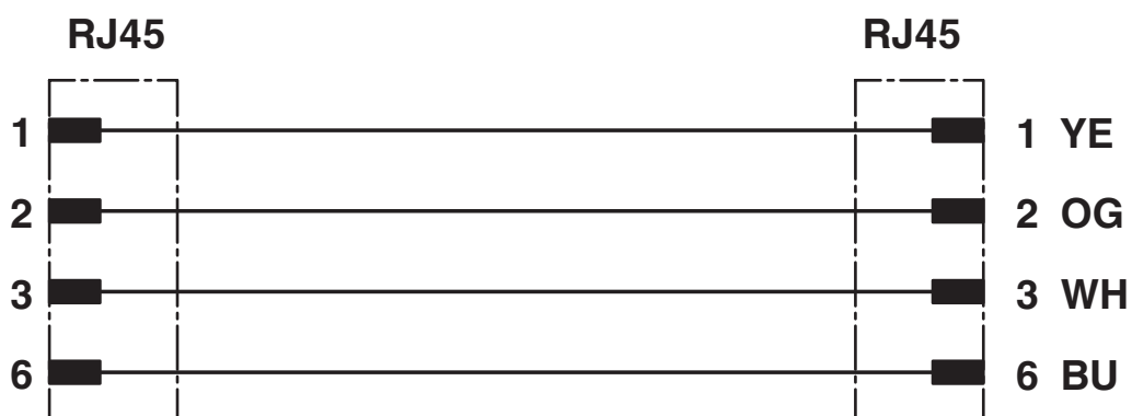
Kontaktbelegung der RJ45-Stecker
