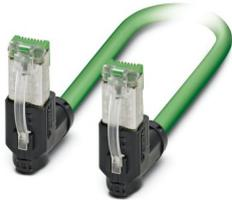
Patch-Kabel, Schutzart: IP20, Kabellänge: 1 m, Polzahl: 4, 100 MBit/s, CAT5, PROFINET, 1x4xAWG22/7, SF/TQ, grün RAL 6018
