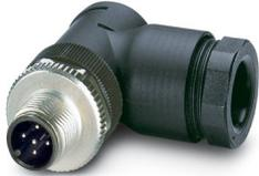
Power-Steckverbinder, 5-polig, Stecker gewinkelt M12, Kodierung: A, Schraubanschluss, Rändelmaterial: Zinkdruckguss, vernickelt, Kabelverschraubung Pg11, Leitungsaußendurchmesser 8 mm ... 10 mm
