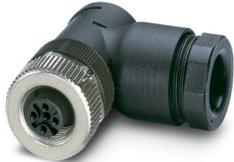
Power-Steckverbinder, 4-polig, Buchse gewinkelt M12, Kodierung: A, Schraubanschluss, Rändelmaterial: Zinkdruckguss, vernickelt, Kabelverschraubung Pg11, Leitungsaußendurchmesser 8 mm ... 10 mm
