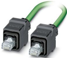
Konfektioniertes PROFINET-Kabel, CAT 5e, geschirmt, Sternvierer, AWG 22 flexibel (7-drähtig), RAL 6018 (gelbgrün), RJ45-Stecker/IP67 Push-Pull Kunststoffgehäuse auf RJ45-Stecker/IP67 Push-Pull Kunststoffgehäuse, Line, Länge: 2 m
