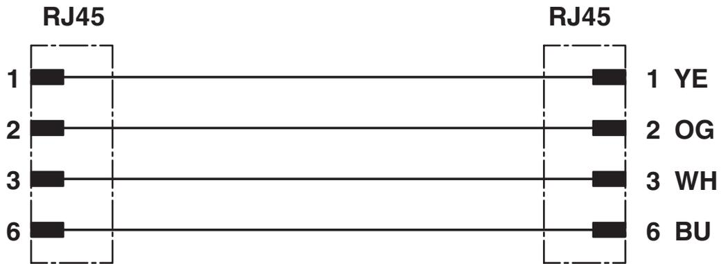
Kontaktbelegung der RJ45-Stecker
