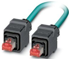
Konfektioniertes Ethernet-Kabel, geschirmt, 4-paarig, AWG 26 flexibel (7-drähtig), RAL 5021 (wasserblau), RJ45-Stecker/IP67 Push-Pull Kunststoffgehäuse auf RJ45-Stecker/IP67 Push-Pull Kunststoffgehäuse, Line, Länge 1 m
