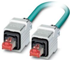
Konfektioniertes Ethernet-Kabel, geschirmt, 4-paarig, AWG 26 flexibel (7-drähtig), RAL 5021 (wasserblau), RJ45-Stecker/IP67 Push-Pull Metallgehäuse auf RJ45-Stecker/IP67 Push-Pull Metallgehäuse, Line, Länge 1 m
