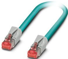
Konfektioniertes Ethernet-Kabel, geschirmt, 4-paarig, AWG 26 flexibel (7-drähtig), RAL 5021 (wasserblau), RJ45-Stecker/IP20 auf RJ45-Stecker/IP20, Line, Länge 5 m
