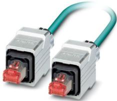
Konfektioniertes Ethernet-Kabel, CAT5e, geschirmt, 2-paarig, AWG 26 flexibel (7-drähtig), RAL 5021 (wasserblau), RJ45-Stecker/IP67 Push-Pull Metallgehäuse auf RJ45-Stecker/IP67 Push-Pull Metallgehäuse, Line, Länge 5 m
