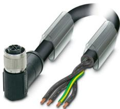
Powerleitung, 4-polig, PUR halogenfrei, schwarzgrau RAL 7021, freies Leitungsende, auf Buchse gewinkelt M12, Kodierung: S, Kabellänge: 1 m, für Wechselstrom bis 12 A/690 V
