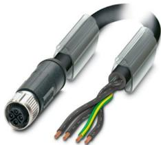
Powerleitung, 4-polig, PUR halogenfrei, schwarzgrau RAL 7021, freies Leitungsende, auf Buchse gerade M12, Kodierung: S, Kabellänge: 1 m, für Wechselstrom bis 12 A/690 V
