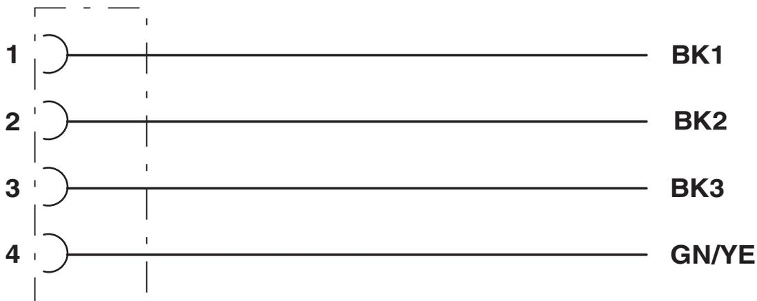
Kontaktbelegung der M12-Buchse
