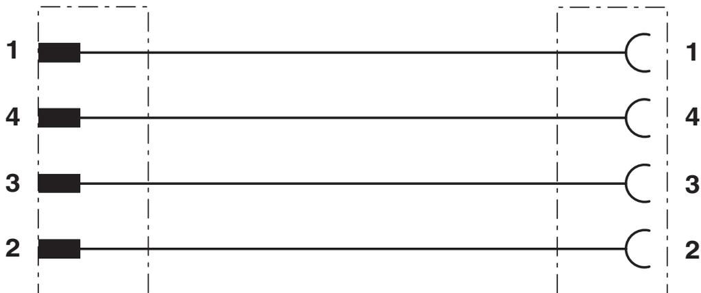
Kontaktbelegung des M12-Steckers und der M12-Buchse
