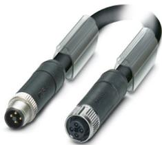
Powerleitung, 4-polig, PUR halogenfrei, schwarzgrau RAL 7021, Stecker gerade M12, Kodierung: T, auf Buchse gerade M12, Kodierung: T, Kabellänge: 10 m, für Gleichstrom bis 12 A / 63 V
