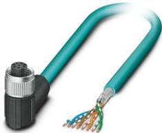
Netzwerkkabel, Ethernet CAT5 (1 GBit/s), 8-polig, PUR halogenfrei, wasserblau RAL 5021, geschirmt, freies Leitungsende, auf Buchse gewinkelt M12, Kodierung: A / IP67, Kabellänge: 10 m
