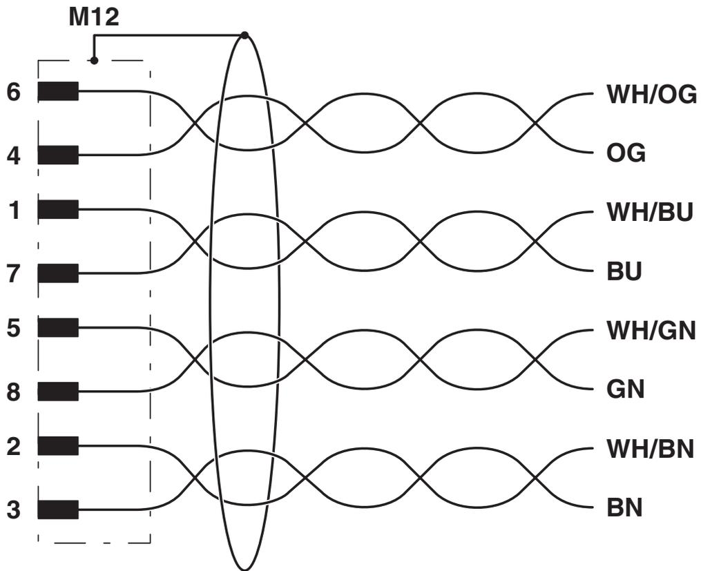
Kontaktbelegung des M12-Steckers
