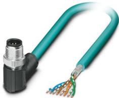
Netzwerkkabel, Ethernet CAT5 (1 GBit/s), 8-polig, PUR halogenfrei, wasserblau RAL 5021, geschirmt, Stecker gewinkelt M12, Kodierung: A / IP67, auf freies Leitungsende, Kabellänge: 10 m
