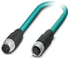
Netzwerkkabel, Ethernet CAT5 (1 GBit/s), 8-polig, PUR halogenfrei, wasserblau RAL 5021, geschirmt, Stecker gerade M12, Kodierung: A / IP67, auf Buchse gerade M12, Kodierung: A / IP67, Kabellänge: 0,5 m
