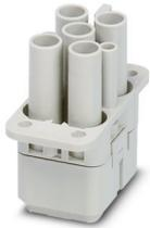
Kontakteinsatz, Polzahl: 4+2+PE, Baugröße: COM, Leistungskontakte: 4, Steuerkontakte: 2, Buchse, Crimpanschluss, 250 V, 40 A, 0,14 mm<sup>2</sup> ... 2,5 mm<sup>2</sup>, Anwendung: Leistung/Signal, nur für Kunststoffgehäuse geeignet
