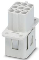
Kontakteinsatz, Polzahl: 8+PE, Baugröße: COM, Leistungskontakte: 8, Steuerkontakte: 0, Anzahl der Anschlüsse je Pol: 1, Buchse, Crimpanschluss, 500 V, 16 A, 0,5 mm<sup>2</sup> ... 4 mm<sup>2</sup>, Anwendung: Leistung, nur für Kunststoffgehäuse geeignet
