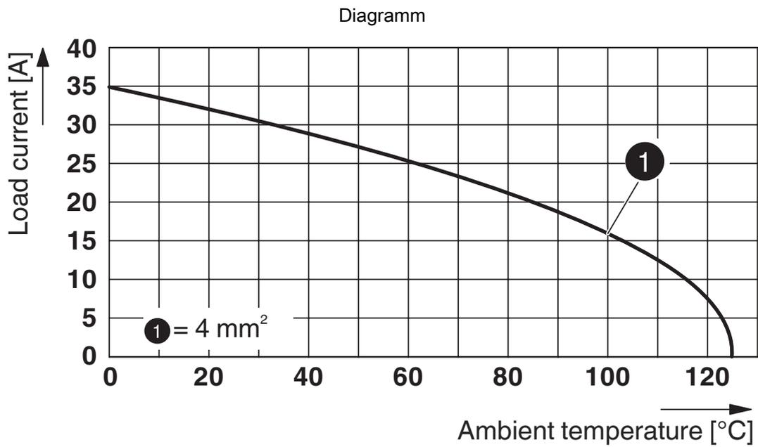
Derating-Diagramm für 4 mm<sup>2</sup>
