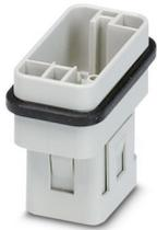
Kontakteinsatz, Polzahl: 8+PE, Baugröße: COM, Leistungskontakte: 8, Steuerkontakte: 0, Anzahl der Anschlüsse je Pol: 1, Stift, Crimpanschluss, 500 V, 16 A, 0,5 mm<sup>2</sup> ... 4 mm<sup>2</sup>, Anwendung: Leistung, nur für Kunststoffgehäuse geeignet
